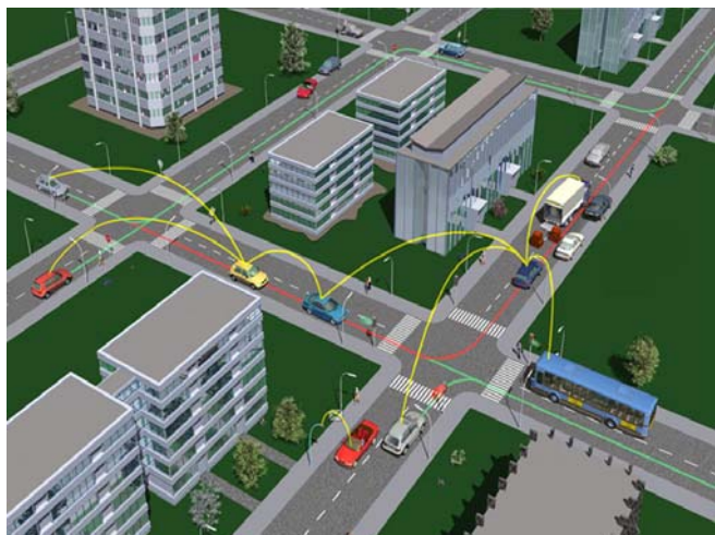
Fig.2 – Comunicazioni tra veicoli in un sistema cooperativo (Fonte: Car2Car Communication Consortium)
