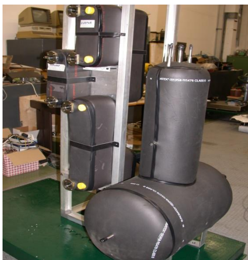
Prototipo da 18 kW frigoriferi - fase di montaggio
