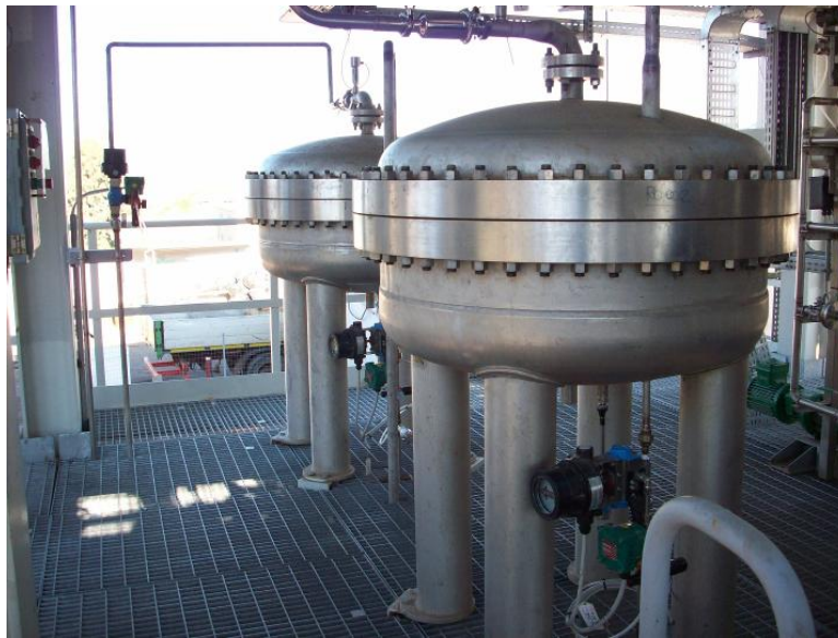
Figura 2.8. Reattori di assorbimento dell'anidride carbonica.
