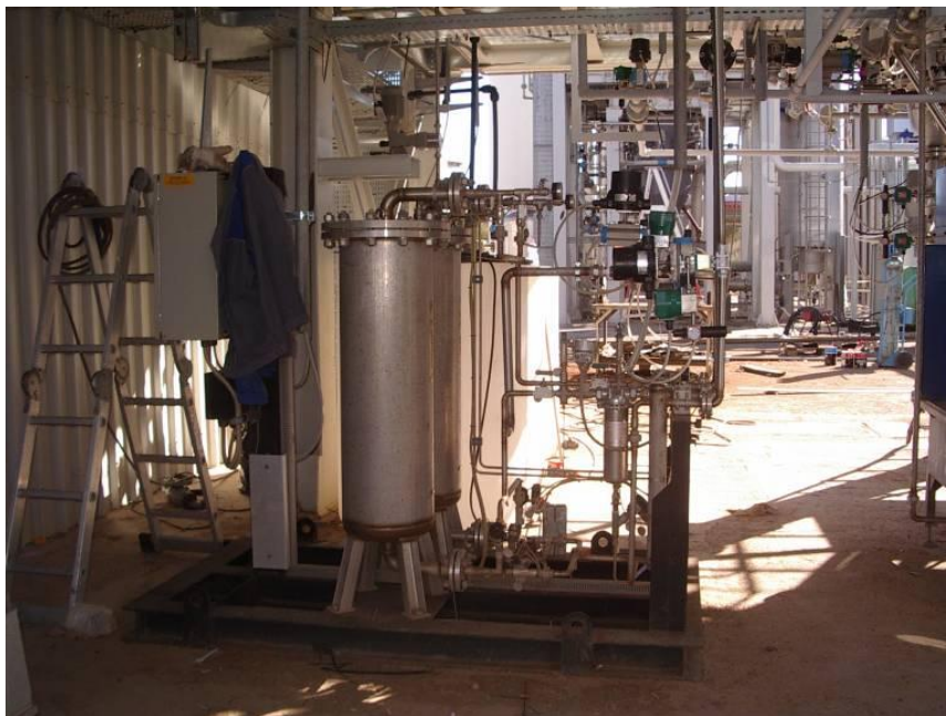
Figura 2.9. Il sistema PSA per la purificazione dell'idrogeno.
