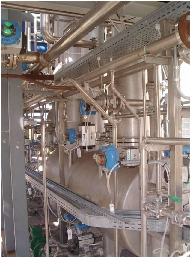
Figura 2.2. Sistema di lavaggio del syngas.
