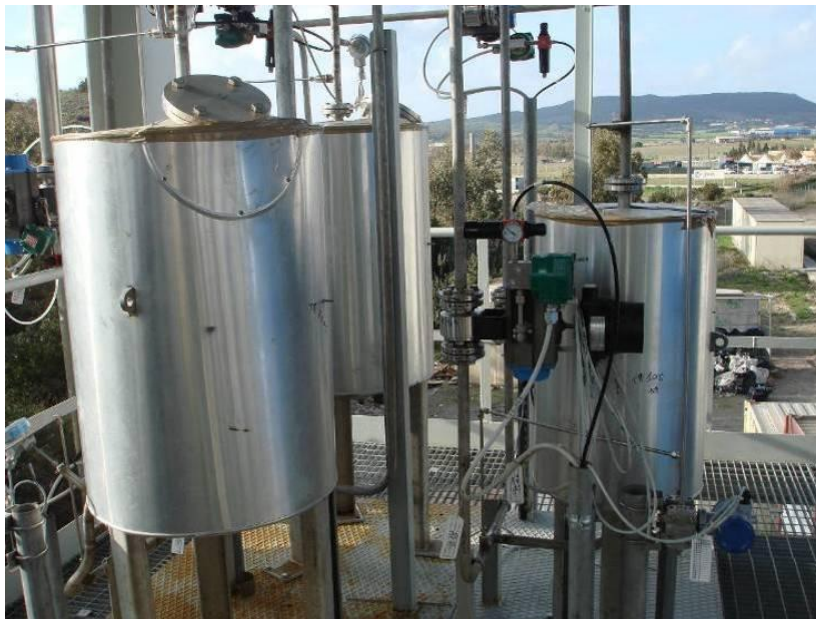
Figura 2.5. Sistema di desolfurazione a caldo del syngas.
